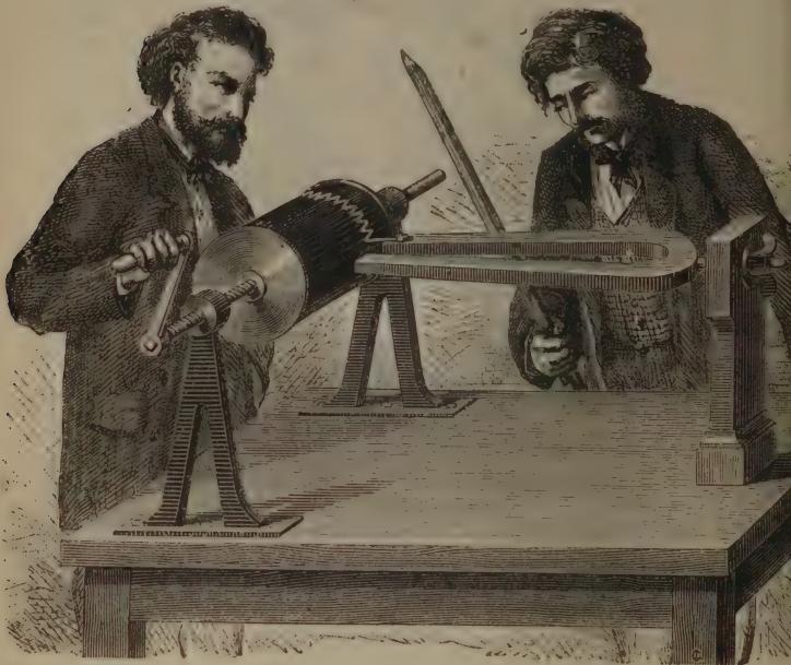
Fig. 25. — Etude graphique et enregistrement des vibrations sonores.
